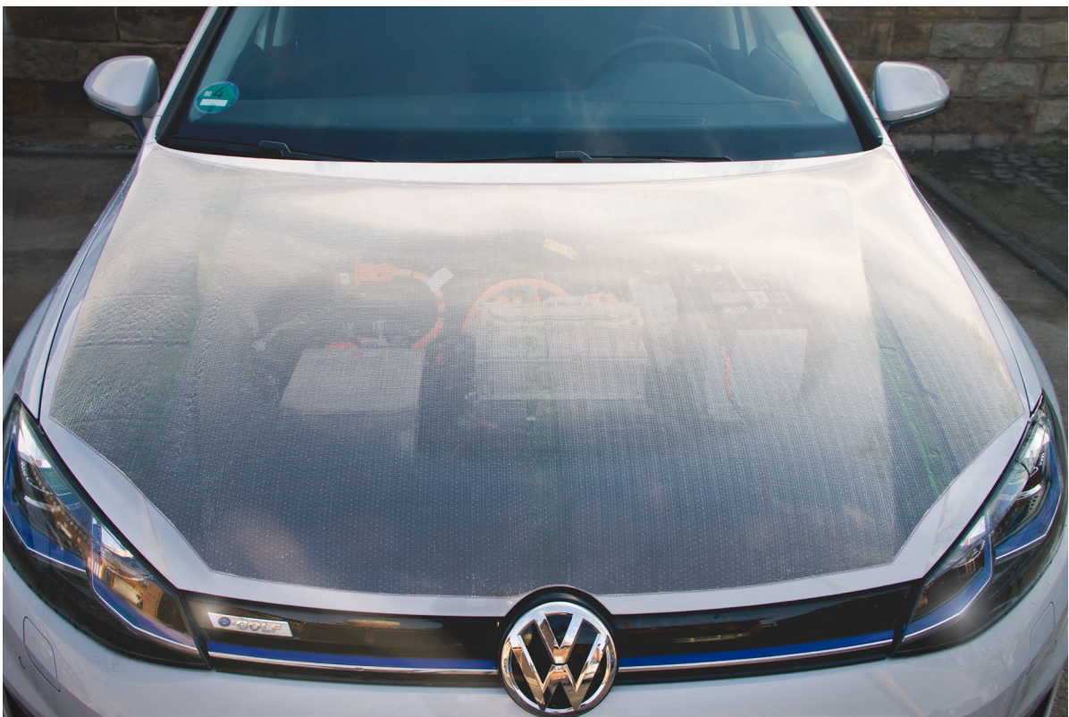
Motorhaube als Beispiel eines großflächigen schnellinfiltrierten FKV-Demonstrators
